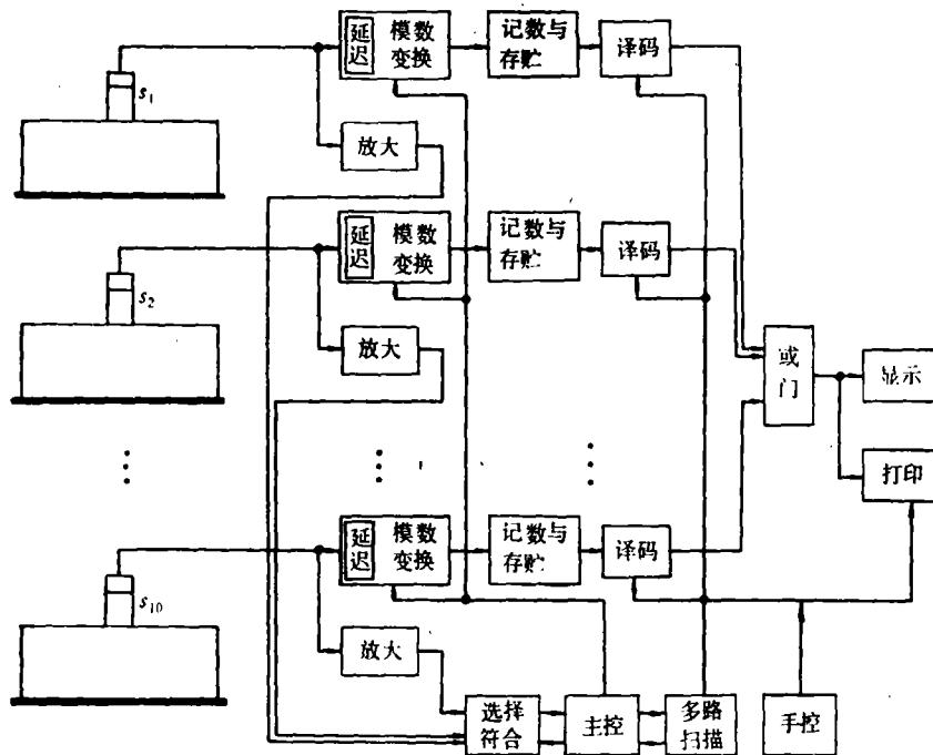
图2 计数器阵记录系统原理图
